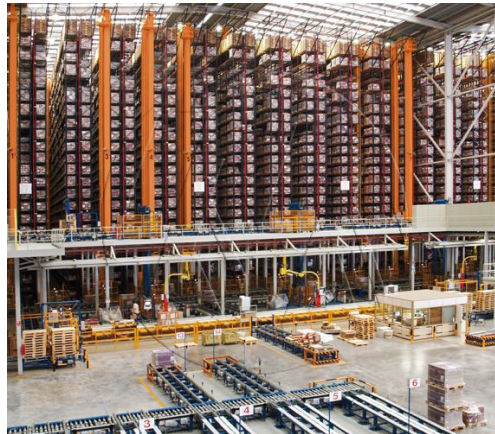
Rys. 3. Widok na magazyn z regałami paletowymi obsługiwany przez układnice paletowe
