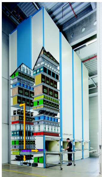
Rys. 2. Wnętrze regału Lean-Lift
