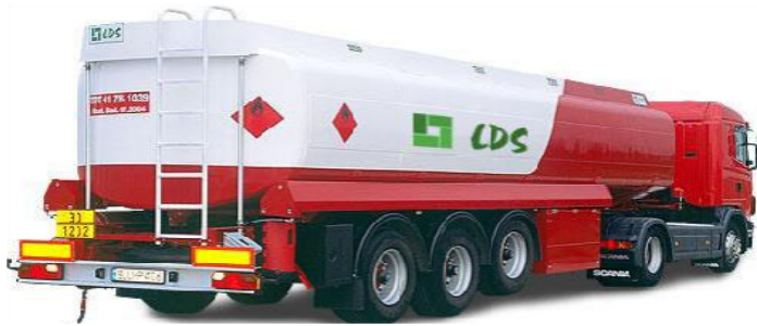
Rysunek 1. Cysterna o przekroju kufrowym
